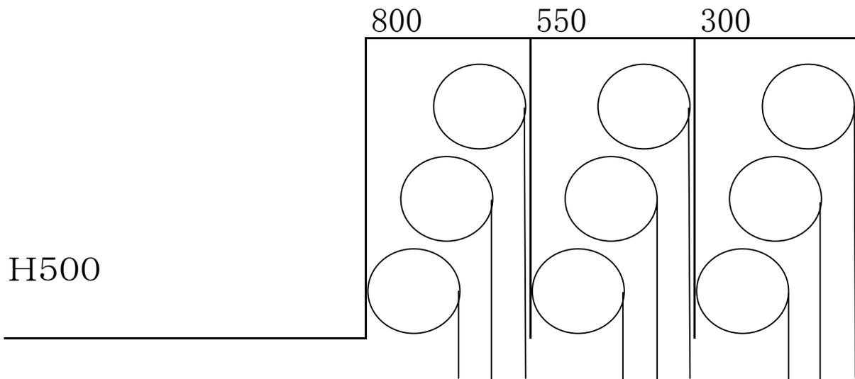
スイッチ取付部よりモーター取付天井部までの入線 VVF1.6x3芯xモーター台数
